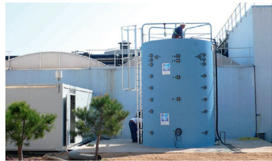
**Le pilote RE-USE (projet Regal) contient une colonne de sol à travers laquelle est injectée de l'eau d'une station d'épuration. Ce réacteur permet d'étudier le pouvoir d'épuration des sols (2009).** © BRGM - J. Casanova
