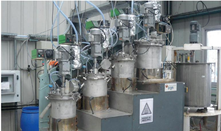
**Installation pilote de traitement par biolixiviation destinée à extraire les métaux contenus dans les minerais sulfurés par biohydrométallurgie.**
