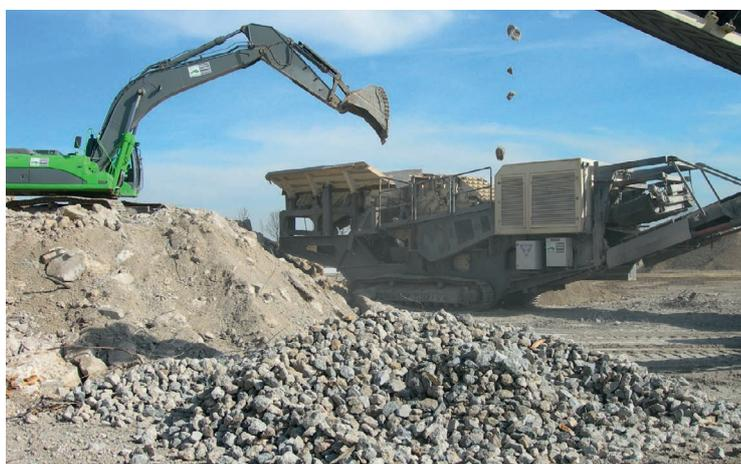
**Station mobile de concassage des bétons de démolition destinés à être recyclés dans le cadre du projet Cofrage (2011).**
