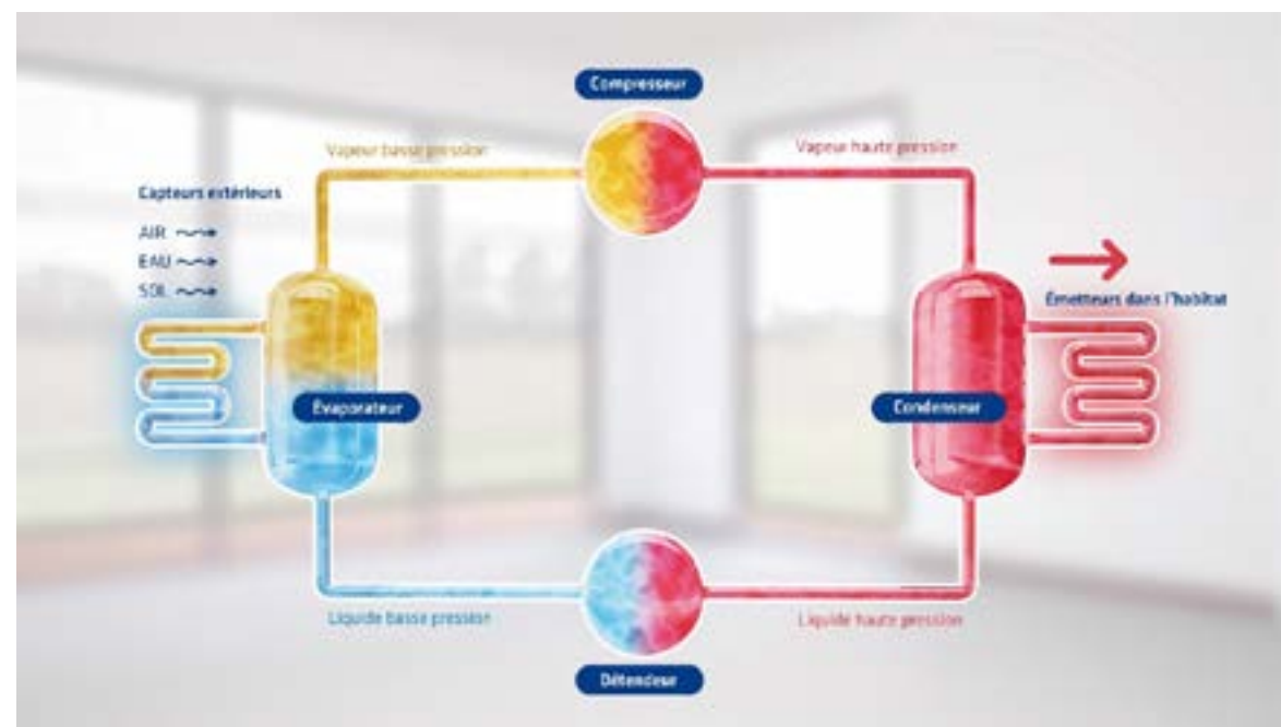
Figure 1. Le fonctionnement d'une PAC. Source : AFPAC
